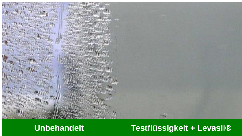
Abb. 1: Benetzung des Fensters durch Regenwasser
