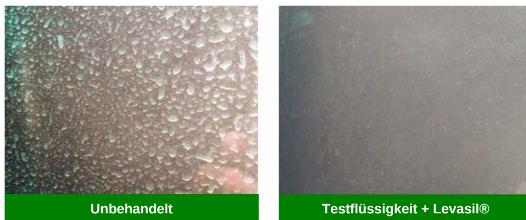
Abb. 3: Glas nach 5 Schmutzwasserzyklen
